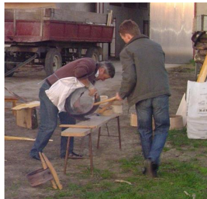
Slika 27 Okruživanje oboda oborka
