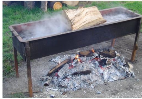
Slika 25 Kanta za kuhanje dasaka za oborkle
